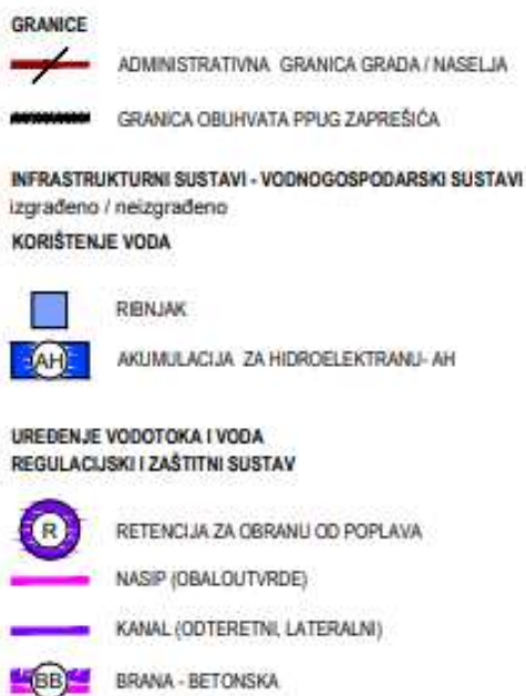
Slika 3.2.2-3. Izvod iz PPUGZ: dio kartografskog prikaza 3.6. Infrastrukturni sustavi – Vodnogospodarski sustavi – Korištenje voda
