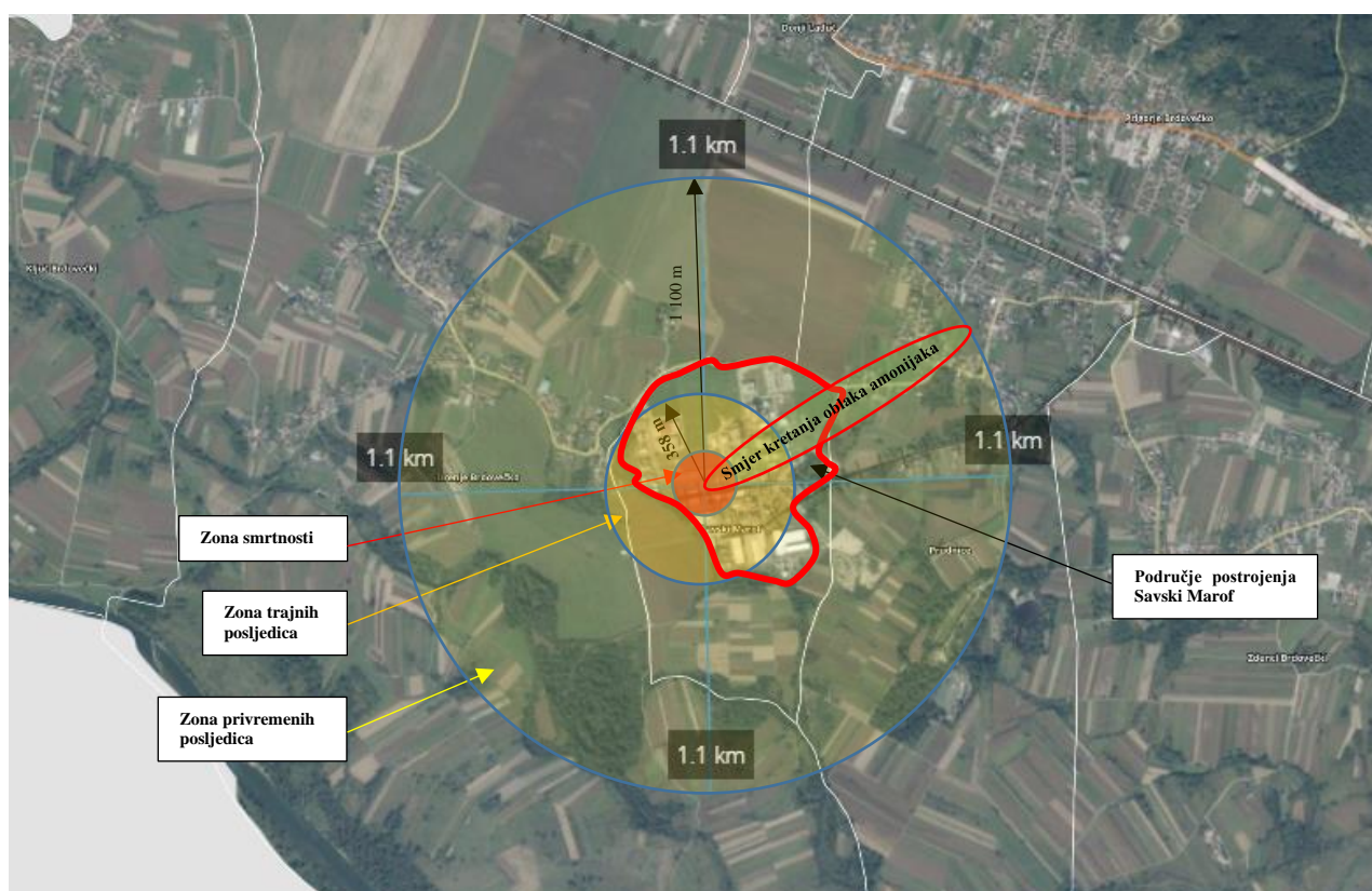
Slika 18: Zona ugroze oblaka amonijaka pri vjetru iz jugozapadnog kvadranta Izvor podataka: Izvješće o sigurnosti Pliva Hrvatska d.o.o.- područje postrojenja Savski Marof, siječanj 2018.; Planovi i Procjene j.d.o.o.
