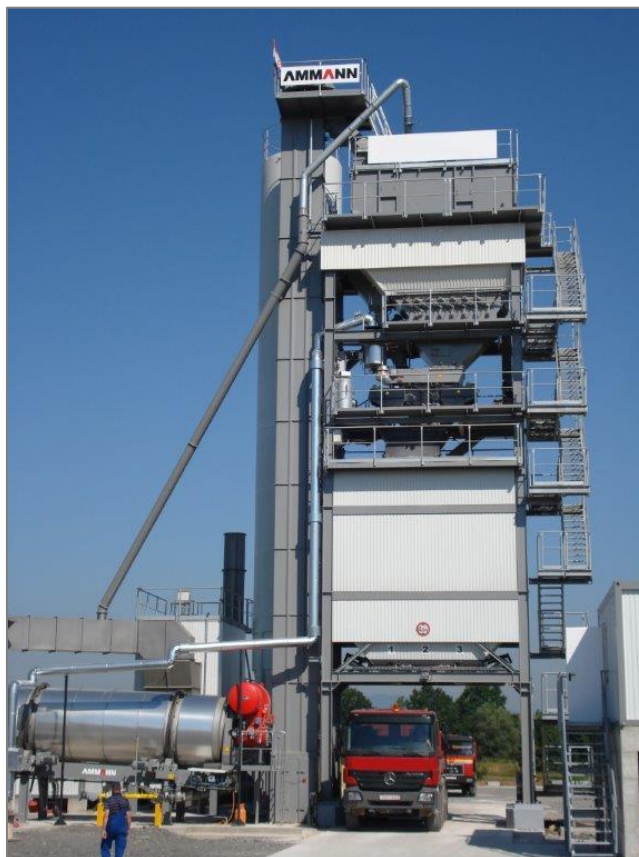
Slika 8. Otprema proizvedenog asfalta transportnim vozilima
