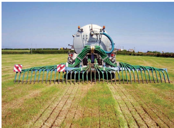
Slika 24. Injektiranje tekućeg stajskog gnoja u travnjak
