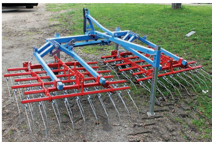
Slika 36. Perasta drljača za travnjake
