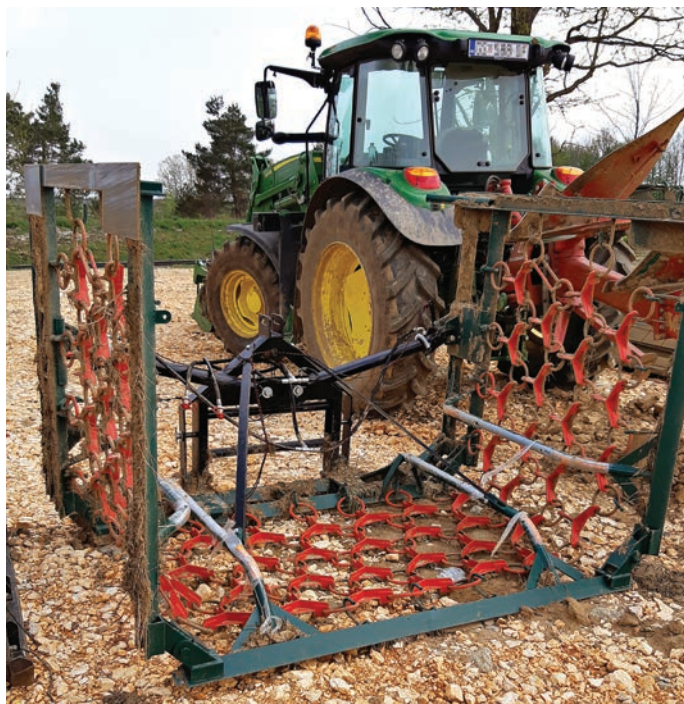
Slika 35. Lančasta drljača za travnjake
