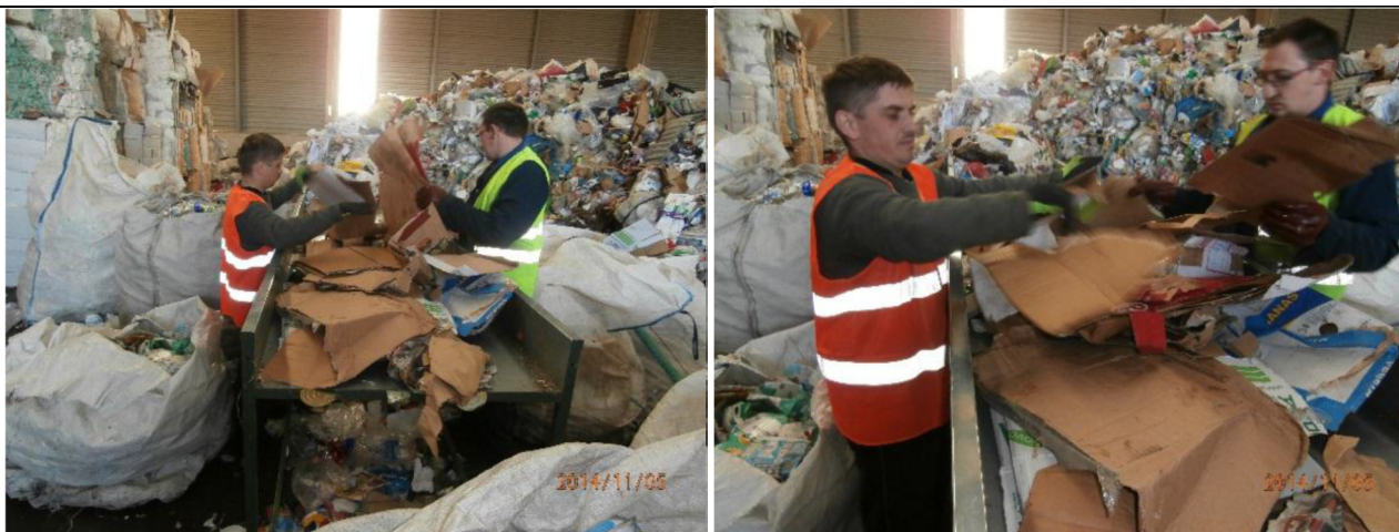
Slike 9 a. i 9 b. Pregled i uklanjanje nedozvoljenih nečistoća iz korisnog otpada
