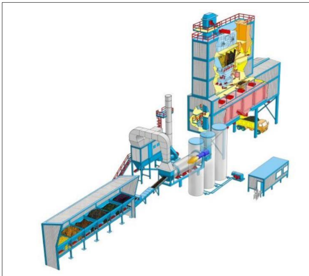
Slika 2. Principijelni izgleda asfaltne baze
