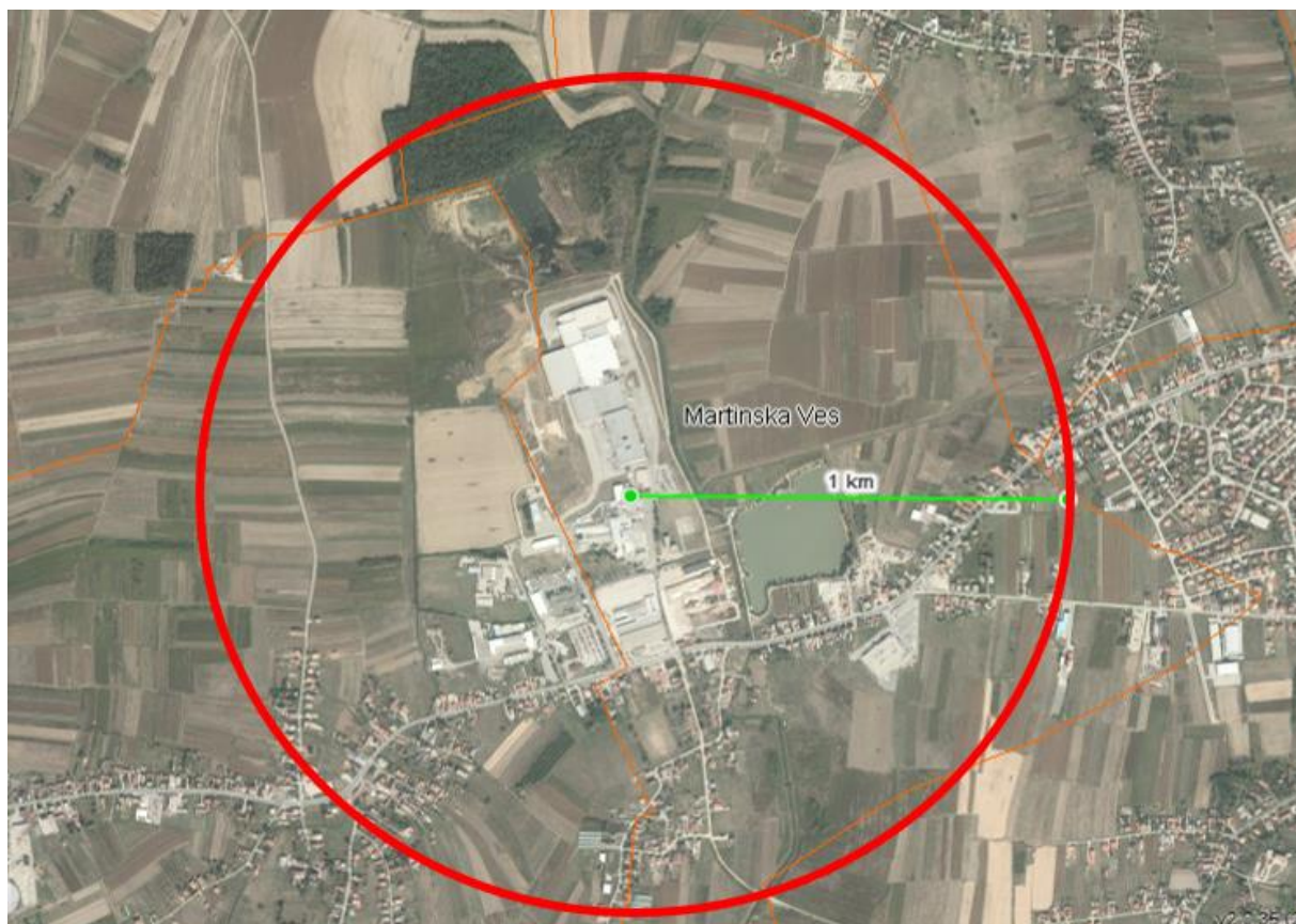
Slika 20: Max. zona ugroženosti u slučaju akcidenta sa amonijakom u strojarnici 1 Izvor podataka: www.arkod.hr i PIK Vrbovec d.d.
